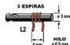
Fig.5 Para construir la bobina L2 hay que envolver 3 espiras de cable de cobre de 0,5 mm de sección sobre un soporte de 3 mm de diámetro. Las espiras se han de espacar para obtener una longitud total de 4 mm.
