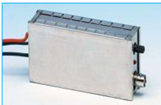
Fig. 24 El Generador Tracking está encerrado dentro un mueble contenedor metálico que lo apantalla completamente. El mueble se proporciona perforado.
