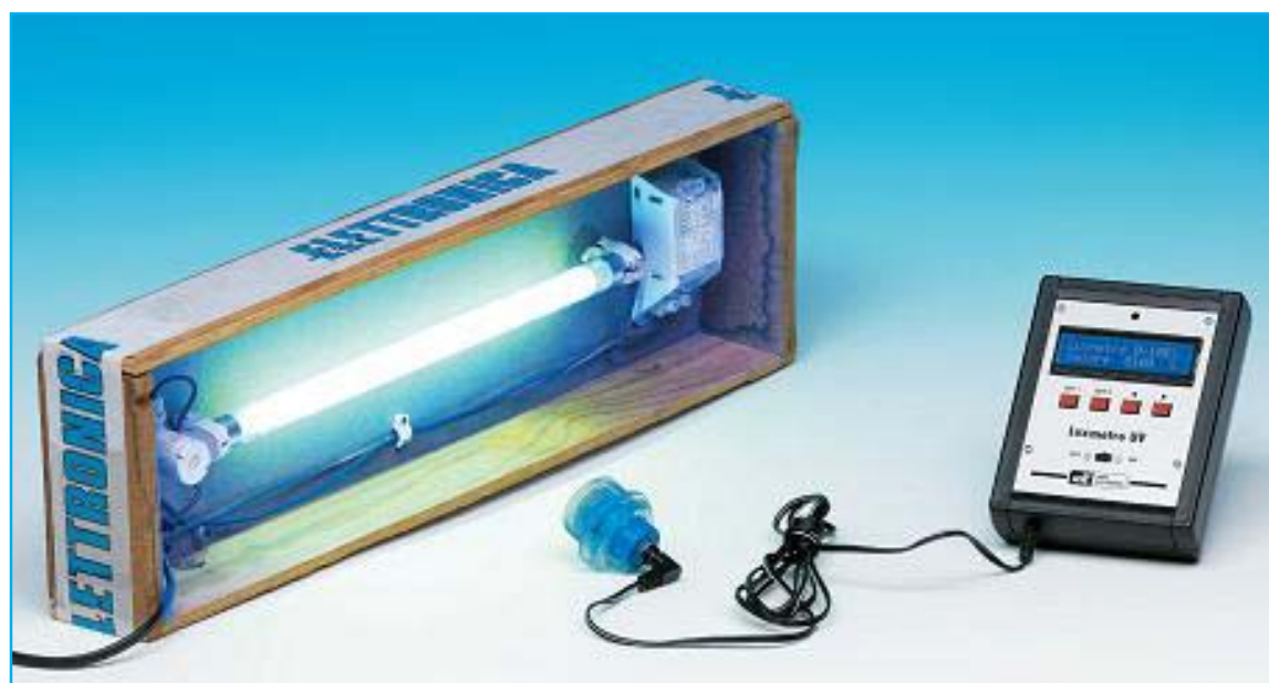
Fig.12 Para calibrar el luxómetro para rayos UV LX.1698 hay que utilizar una lámpara que emita rayos ultravioletas, como nuestra lámpara germicida de 8 W LX.1183. Este kit, que incluye reactancia y cebador, podemos proporcionarlo bajo petición expresa.
