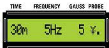
Fig.5 Si bajo la referencia PROBE aparecen alternativamente los símbolos Y V significa que la Magnetoterapia está irradiando adecuadamente un campo magnético.
