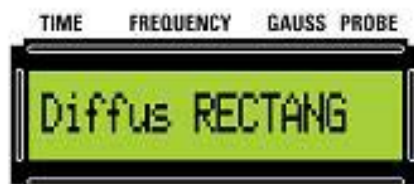
Fig. 10 Apagando el aparato cuando se muestra esta indicación se selecciona el uso de difusores rectangulares.
