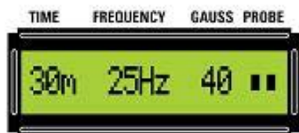
Fig.6 Un rectángulo indica que se ha seleccionado la utilización de difusores rectangulares. Con estos difusores se pueden seleccionar tres valores de potencia: 20, 30 o 40 gauss.
