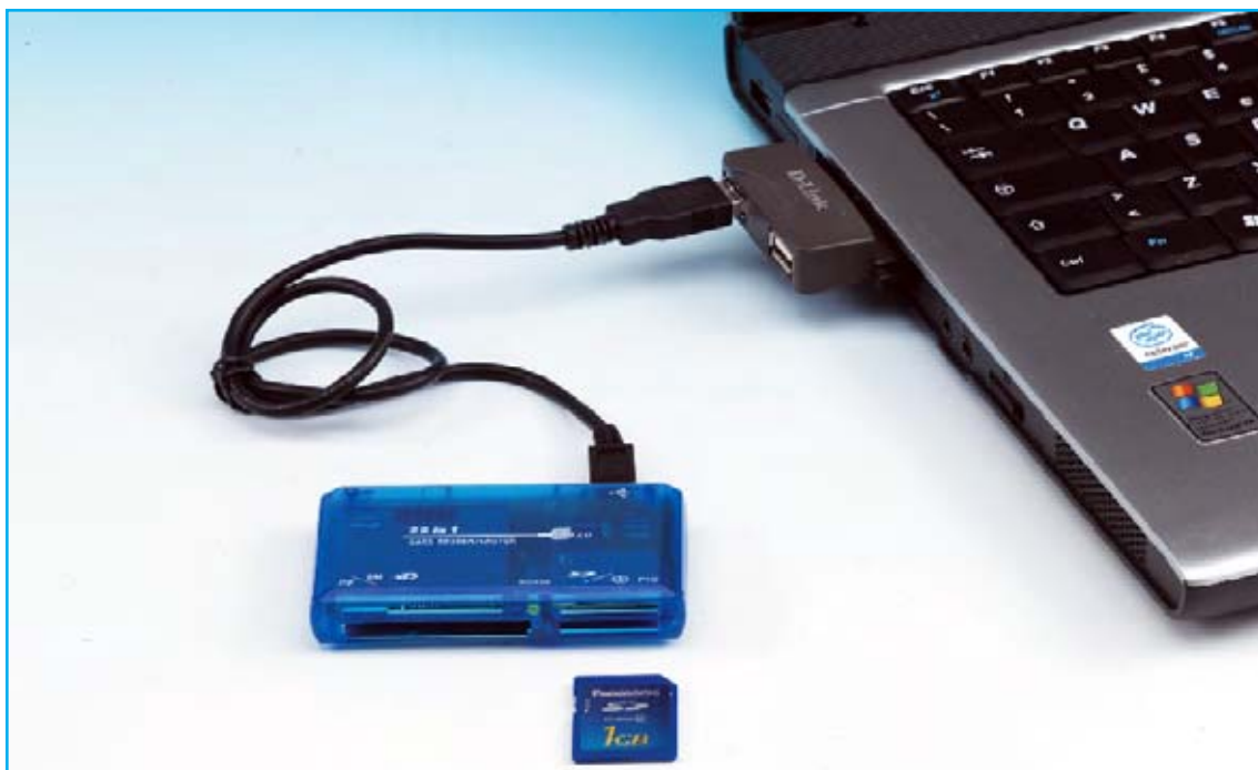
Fig.28 Para extraer los datos almacenados en la memoria SD hay que introducirla en un lector de tarjetas. Si el ordenador no dispone de lector se puede conectar uno externo vía USB, como el aquí mostrado. Los datos se almacenan en el archivo GeigerNE.TXT, pudiéndose llevar a una hoja Excel para realizar estadísticas y gráficos.
