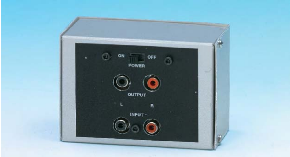
Fig.17 Aspecto final del Preamplificador RIAA estéreo LX.1706 una vez cerrado el mueble contenedor. El mueble se proporciona adecuadamente perforado y con un panel adhesivo de color negro serigrafiado.
