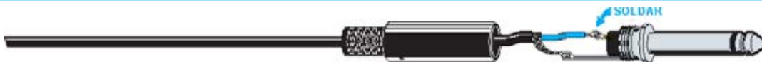
Fig.7 El cable procedente de las cajas acústicas debe soldarse a los dos terminales del conector jack macho. El terminal más largo es masa, por lo que en caso de utilizar cable apantallado es conveniente soldar la malla protectora en este terminal.
