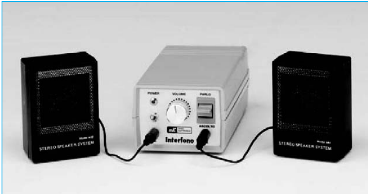
Fig.1 El interfono está compuesto por un amplificador conmutado alojado en un pequeño mueble contenedor. Para llevar la voz de la caja acústica izquierda a la derecha, o viceversa, hay que actuar sobre la palanca del conmutador S1, situado en el lado derecho del panel. También se incluyen controles para el encendido y para el volumen.
