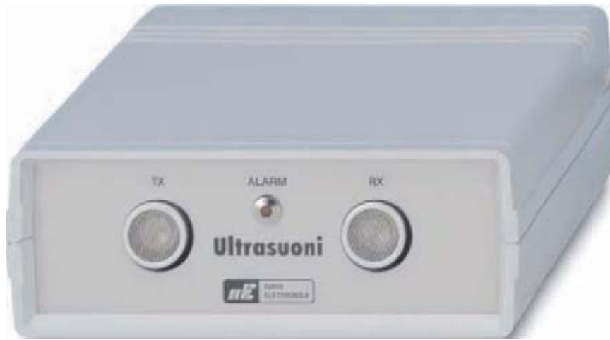
Fig.1 Nuestro antirrobo por ultrasonidos ya dispuesto en su mueble de plástico.
