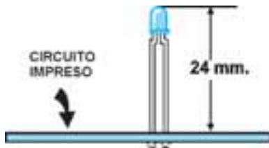
Fig.11 Al insertar los dos terminales del LED DL1 en el circuito impreso, el más largo coincidirá con el taladro marcado con la letra A. Antes de soldarlo tenemos que separar el cuerpo del LED de la placa una distancia de 24 mm.
