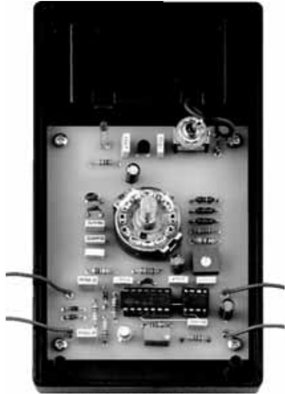
Fig.12 Después de soldar todos los componentes necesarios, podemos fijar la placa al mueble de plástico mediante 4 tornillos autorroscantes.
