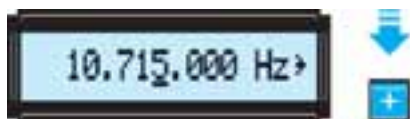
Fig.6 Manteniendo pulsadas las teclas "+" o "-" la frecuencia aumenta o disminuye progresivamente. Si utilizamos estos pulsadores para elegir la frecuencia ya no es necesario presionar la tecla "#" para su confirmación.
