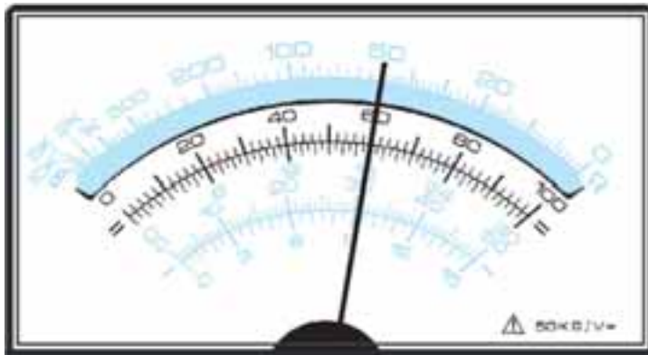
Fig.9 Aunque en los t ester aparecen varias escalas graduadas, para una lectura m as sencilla emplearemos la de 0 a 100.
