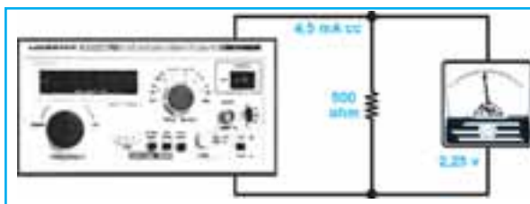
Fig.3 Cuando circula por una resistencia de 500 ohmios una corriente de 4,5 mA, la tensión en sus extremos será de (4,5 \times 500) : 1,000 = 2,25 voltios.
