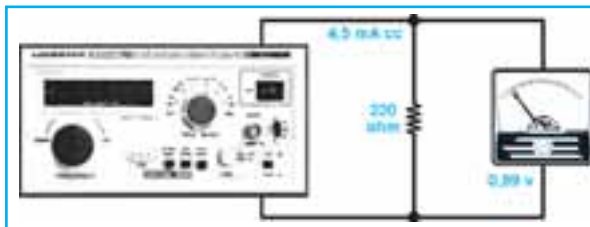
Fig.2 Cuando circula por una resistencia de 220 ohmios una corriente de 4,5 mA, la tensión en sus extremos será de (4,5 \times 220) : 1,000 = 0,99 voltios.
