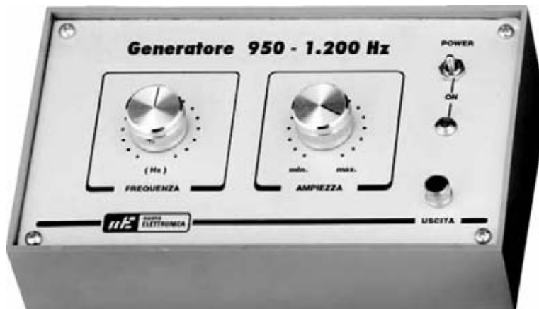
Fig.7 foto del panel frontal fijado al circuito visto desde arriba. El panel frontal se colocará sobre el móvil de plástico a modo de consola (ver fig.8) con 4 tornillos a rosca.
