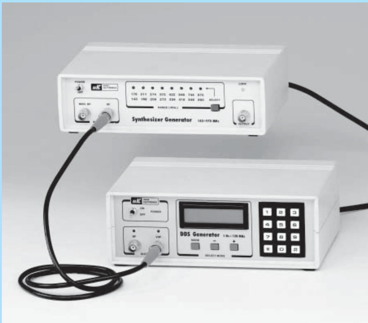
Fig.3 la salida VHF del Generador DDS, que ya os hemos presentado en anteriores revistas, se conectará a través de una cable coaxial, en el BNC de entrada de nuestro sintetizador. Apretando la tecla Select si encenderá en el panel frontal el diodo led relativo a su gama de trabajo. En la entrada de este Sintetizador también podéis insertar la señal extraída de cualquier Generador o VFO siempre que se genere una frecuencia entre los 14,3 Mhz y 97,0 Mhz (ver tabla N.1).
