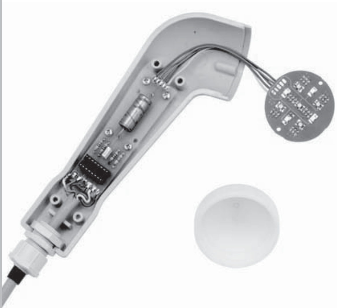
Fig.23 he aquí el mando una introducida la tarjeta LX.1761 y la tarjeta SMD KM1761K que contiene los diodos led.
