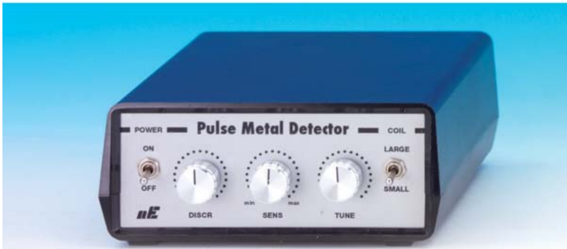
Fig.12 foto del mueble de plástico MO1765 que hemos utilizado para acoger el circuito del buscametales LX.1765, y del alimentador LX.1766
