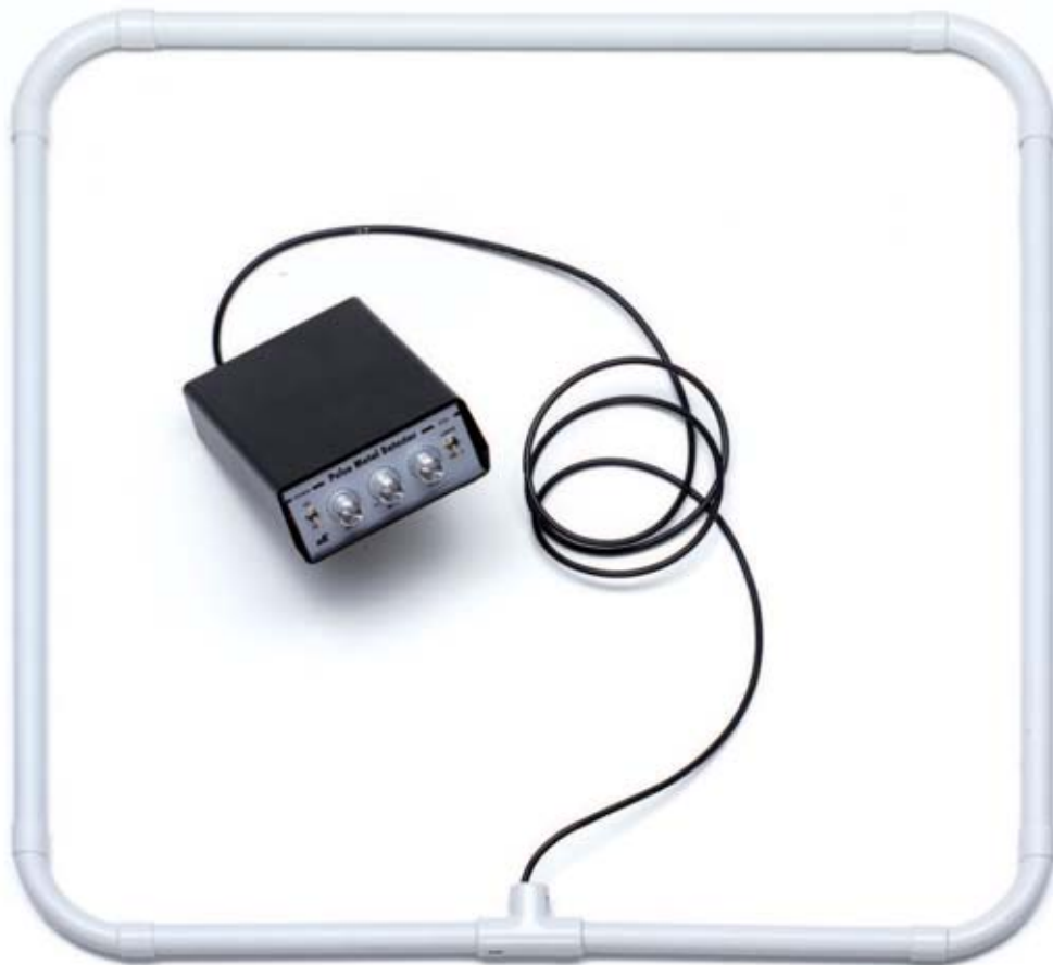
Fig.17 foto de la bobina cuadrada que hemos utilizado para realizar los test del circuito y las pruebas prácticas.
