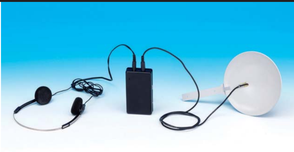
Fig.1 en esta foto se puede ver como se presenta el proyecto del convertidor LX.1770 con el que podéis escuchar los ultrasonidos.
