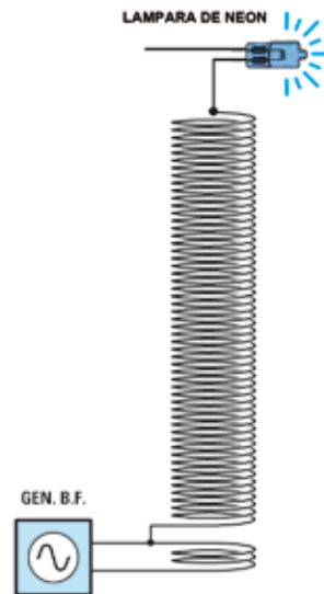
Fig.5 Para estimar la frecuencia de resonancia de una bobina es suficiente con fabricar un circuito como el que se muestra en la figura. Se utiliza un generador de onda sinusoidal conectado a un link de 5-10 espirales envueltas en la bobina que se medirá. Un extremo de la bobina está conectado al generador, mientras que el otro está conectado a un terminal con una pequeña bombilla de neón.
