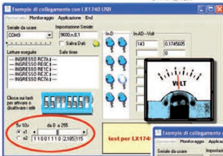
Fig.13 Desde el puerto USB comenzará el flujo de datos relacionados con la tensión que aparecerá en la parte inferior izquierda.
