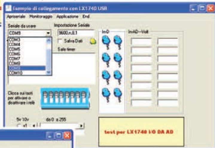
Fig. 12 Seleccione el puerto COM, que en nuestro caso es COM9 que es y haga clic a continuación en el menú superior para Abrir puerto serie.
