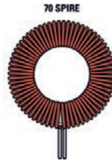
Fig.15 En la figura se puede ver la inductancia L1 que se tendrá que realizar dando 70 vueltas alrededor del pequeño núcleo toroidal que está en el blister del kit. También en este caso el alambre de cobre para este bobinado tiene una sección transversal de 0,5 mm.
