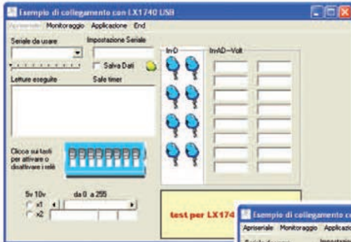
Fig. 12 Seleccione el puerto COM, que en nuestro caso es COM9 que es y haga clic a continuación en el menú superior para Abrir puerto serie.
