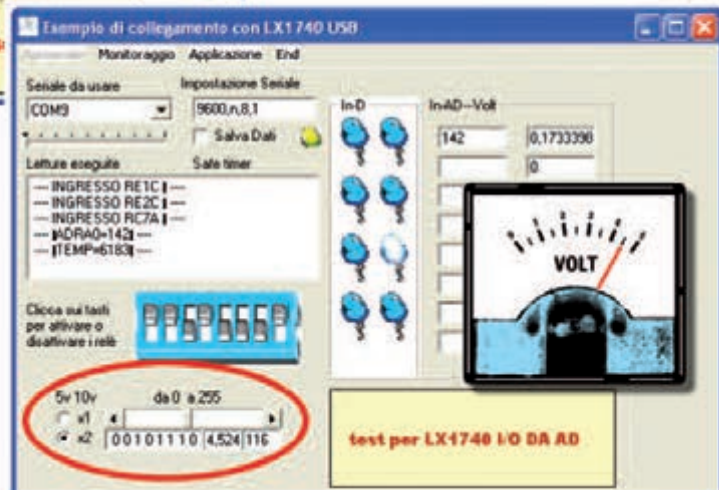
Fig. 14 Seleccione en la casilla correspondiente x1 o x2 según si el trimmer se gira al máximo o al mínimo. La tensión de salida puede variar entre 0-5 V o entre 0-10 V.
