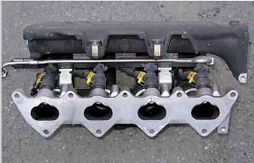
Fig.10 Foto de los inyectores en el distribuidor de combustible.
