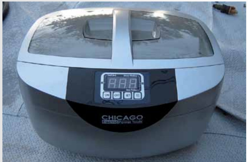
Fig. 11 Pequeña lavadora de ultrasonidos que se utiliza para eliminar impurezas e depósitos presentes en los inyectores.
