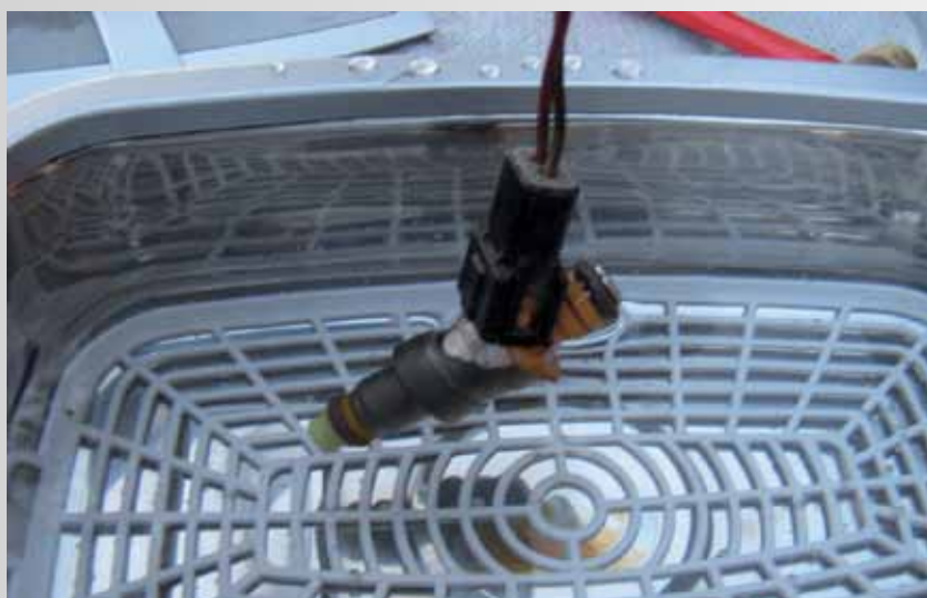
Fig. 12 Para una limpieza más profunda, se recomienda utilizar una máquina de ultrasonidos a 70 grados.
