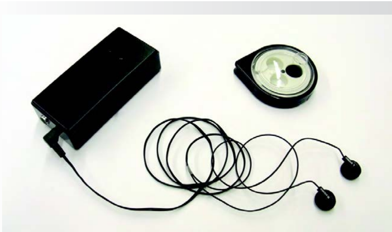
Fig.1 Foto del micrófono estéreo preamplificado una vez terminado el montaje.
