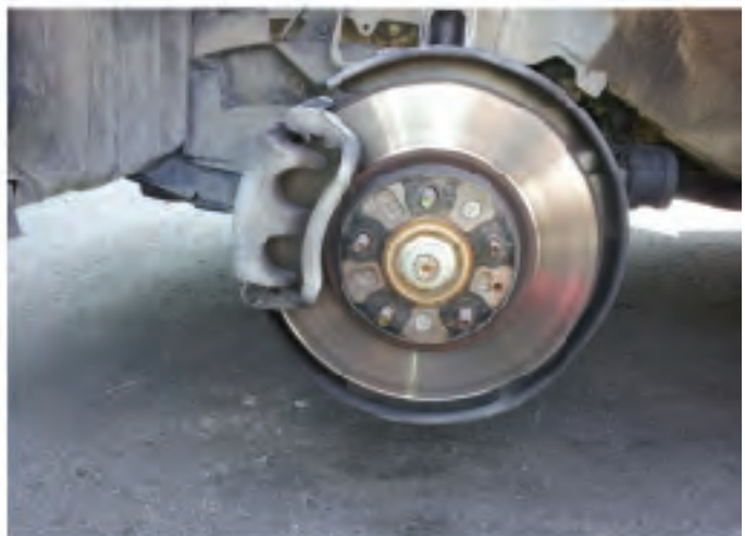
Fig.5 Durante el test hemos tomado alguna foto para haceros ver donde hallan los cables de la señal del ABS. Naturalmente cada vehículo tiene su propia "geografía" por lo que si no son profesionales deberían obtener ayuda de un electricista. En nuestro caso se trata de un SUV Toyota. Como puede ver, hemos desmontado el neumático para poder acceder a la corona.
