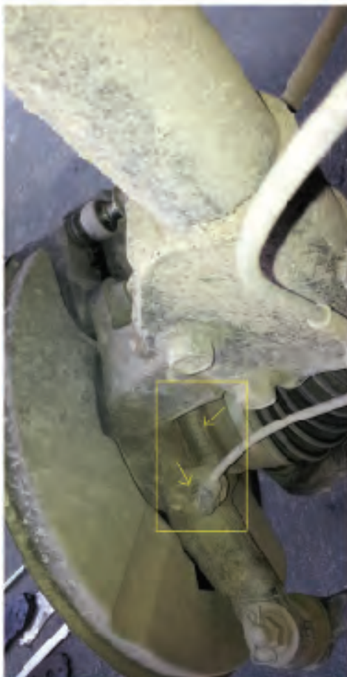
Fig.5 Durante el test hemos tomado alguna foto para haceros ver donde hallan los cables de la señal del ABS. Naturalmente cada vehículo tiene su propia "geografía" por lo que si no son profesionales deberían obtener ayuda de un electricista. En nuestro caso se trata de un SUV Toyota. Como puede ver, hemos desmontado el neumático para poder acceder a la corona.
