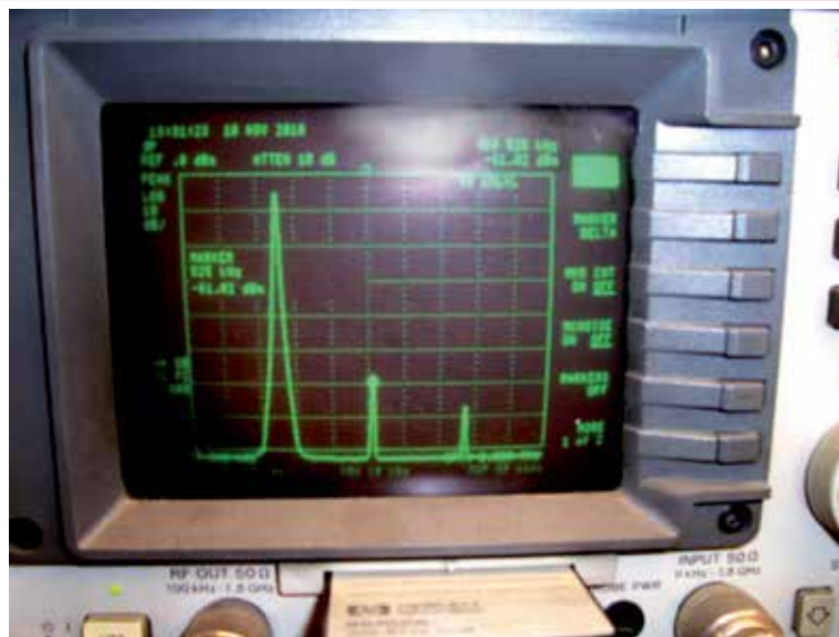
En la figura 22 la pantalla del analizador de espectro aparece a la izquierda del pico de cero, derecha del pico con respecto a la frecuencia fundamental y, en el lado, el pico en relación con el segundo armónica. Como vemos el pico de emisión electromagnética con respecto a la frecuencia fundamental tiene una amplitud de aproximadamente -60 dB , que es insignificante.
