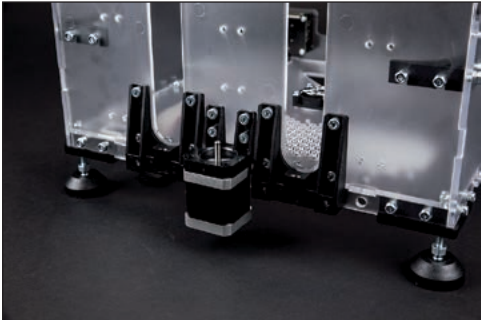
Fig. 22 - Montaje del motor paso a paso del eje Z.
