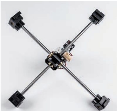
Fig. 31 - Las varillas guía van introducidas en los agujeros del soporte del cabezal e introducidos en los cojinetes de las paredes.
