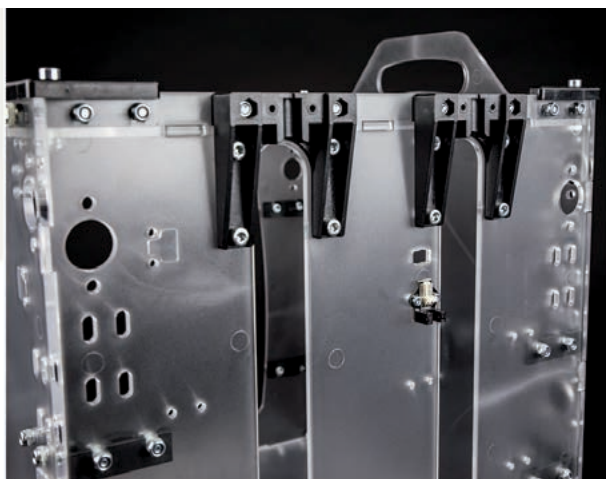
Fig. 17 - Final de carrera con los aisladores de los tornillos montados y montaje del final de carrera Z.
