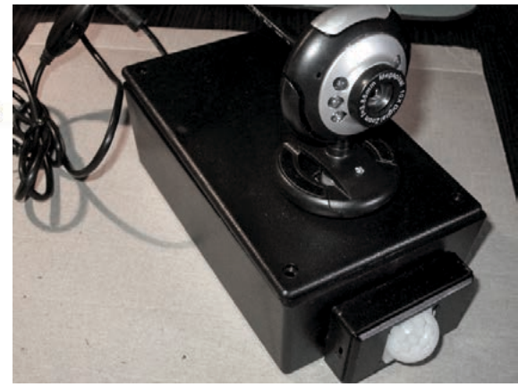
Fig. 1b - Webcam con giro y PIR para detección intrusión.
