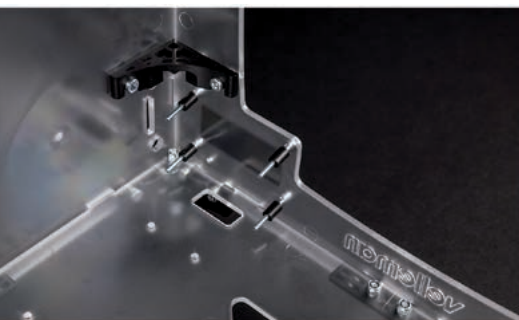
Fig. 15 - Montaje del panel de control de la impresora.
