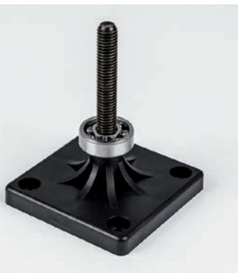
Fig. 12 - Para realizar el soporte giratorio para la bobina se monta sobre la base roscada un par de cojinetes separados por tuercas autoblocantes.
