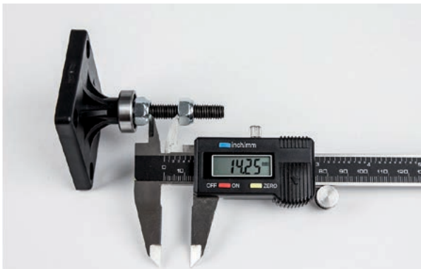
Fig. 12 - Para realizar el soporte giratorio para la bobina se monta sobre la base roscada un par de cojinetes separados por tuercas autoblocantes.
